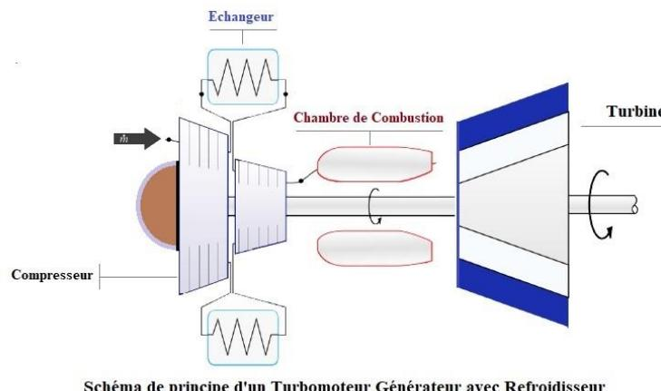
Schéma de principe d'un Turbomoteur Générateur avec Refroidisseur
